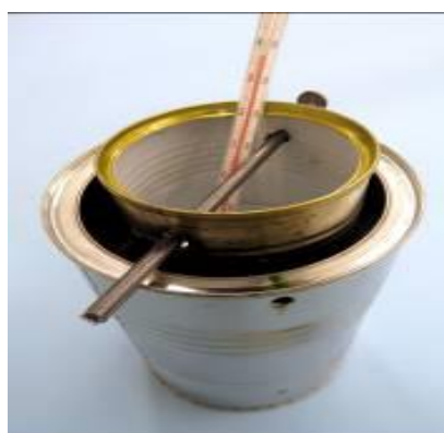
Obrázok 5.4: Meranie teploty vody v kalorimetri
