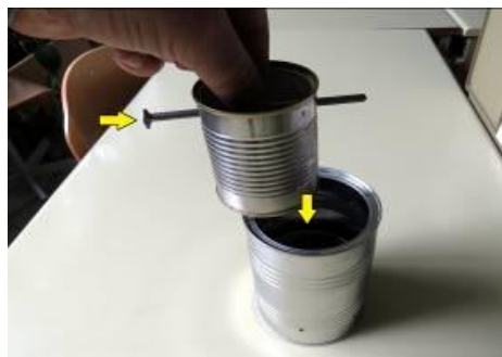
Obrázok 5.3 A: Výroba kalorimetra
