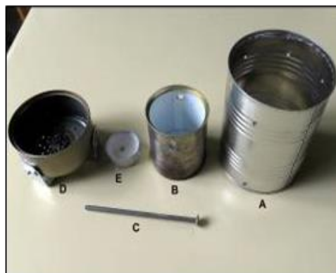
Obrázok 5.2: Pomôcky na výrobu kalorimetra
