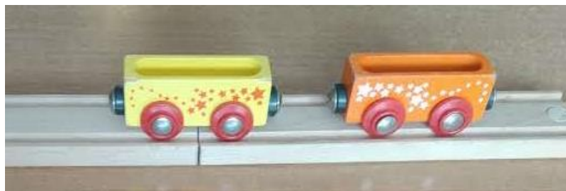
Obr. 3 Vozíky otočené tak, aby sa navzájom prostredníctvom magnetov odtláčali, využijeme pri pružných zrážkach vozíkov.
