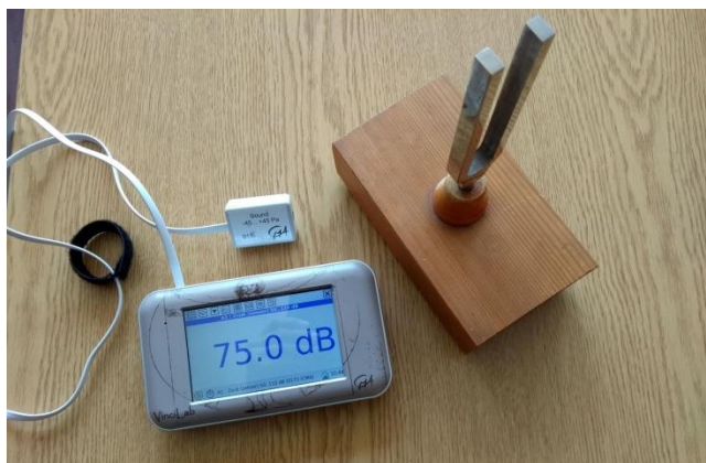
Obr. VinciLab so senzorom zvuku, merací rozsah v decibeloch
