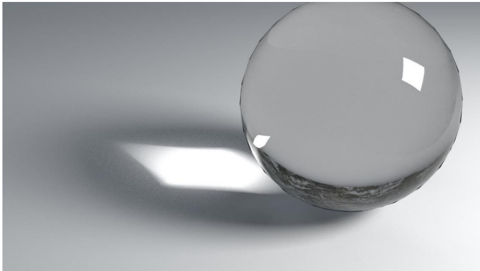
Obrázok 27 Ukážka kaustiky – obálka lúčov premietnutá na podložke je deformovaná po prechode priehľadným zakriveným objektom – guľou.
