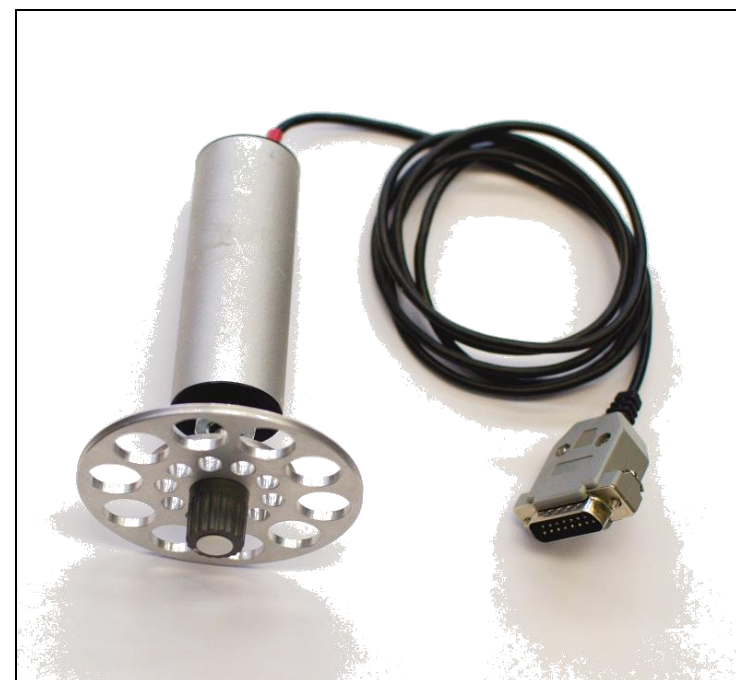
Obrázok 10 Vstupný modul – ISES potenciometer pre merania polohy navinutým lankom na hliníkovom kotúči
