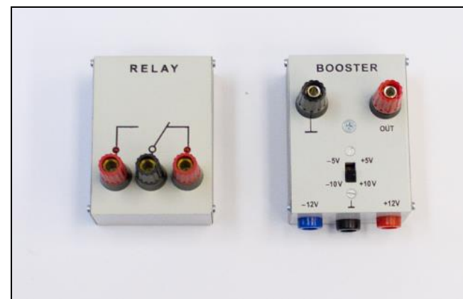
Obrázok 8 Výstupné moduly – ISES relé a ISES prúdový zosilňovač výstupu (pozn.: k prúdovému zosilňovaču treba pripojiť externý zdroj napätia)
