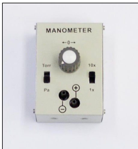
Obrázok 13 Vstupný modul – ISES manometer na merania pretlaku a podtlaku
