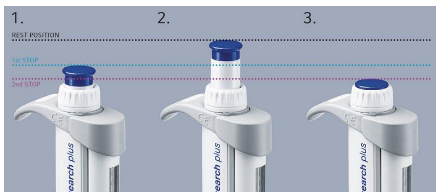
Obr. 2. Pipetovanie smerom dopredu – priame pipetovanie.
