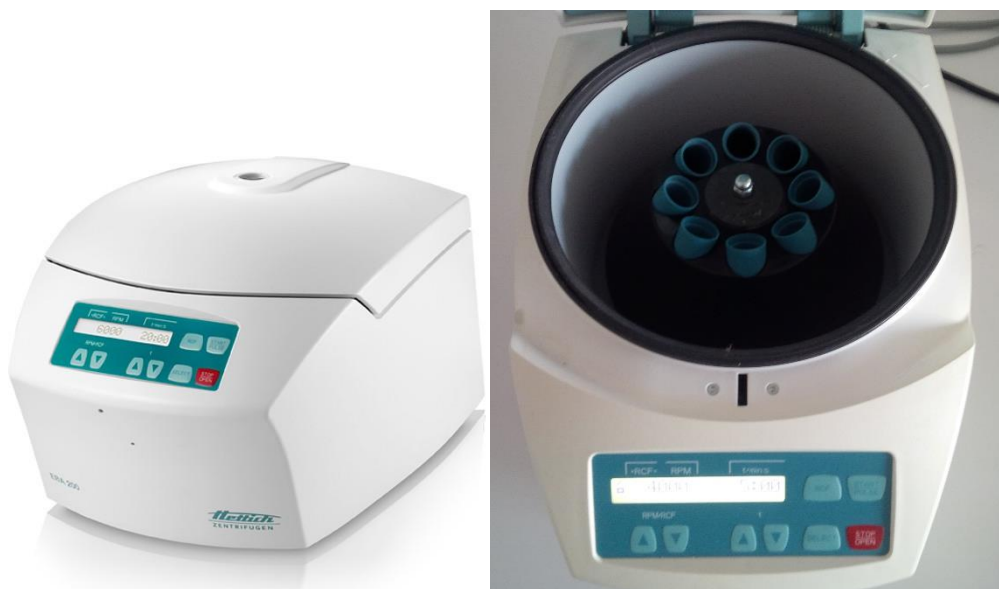
Obr. 22. Centrifúga Hettich Eba 200 s uhlovým rotorom používaná v Laboratóriu organickej chémie a biochémie.
