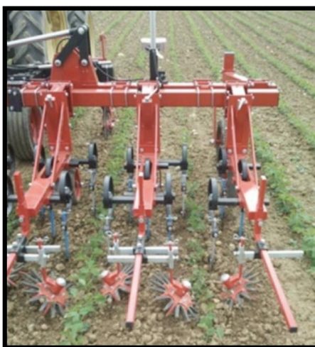
Obrázok 31- Zariadenie používané pri mechanickej kontrole burín v poľnohospodárstve
