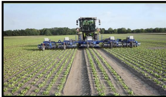
Obrázok 34- Počítačovo riadené zariadenie používané pri mechanickej kontrole burín v poľnohospodárstve
