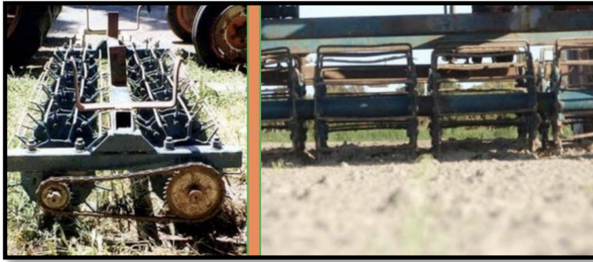
Obrázok 33- Zariadenie používané pri mechanickej kontrole burín v poľnohospodárstve
