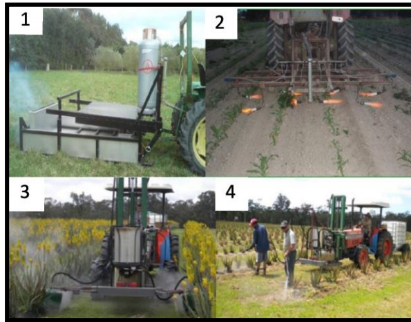
Obrázok 35- Termické metódy zneškodňovania burín v poľnohospodárstve (1-parné zneškodňovanie, 2- plameňové zneškodňovanie, 3,4- zneškodňovanie burín pomocou horúcej pary)
