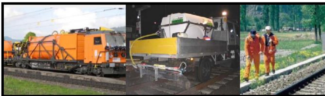
Obrázok 42- Rôzne metódy aplikácie pesticídov na železničných tratiach
