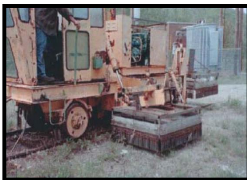
Obrázok 48- Mechanizmus, ktorý využíva infračervené žiarenie pri zneškodňovaní burín
