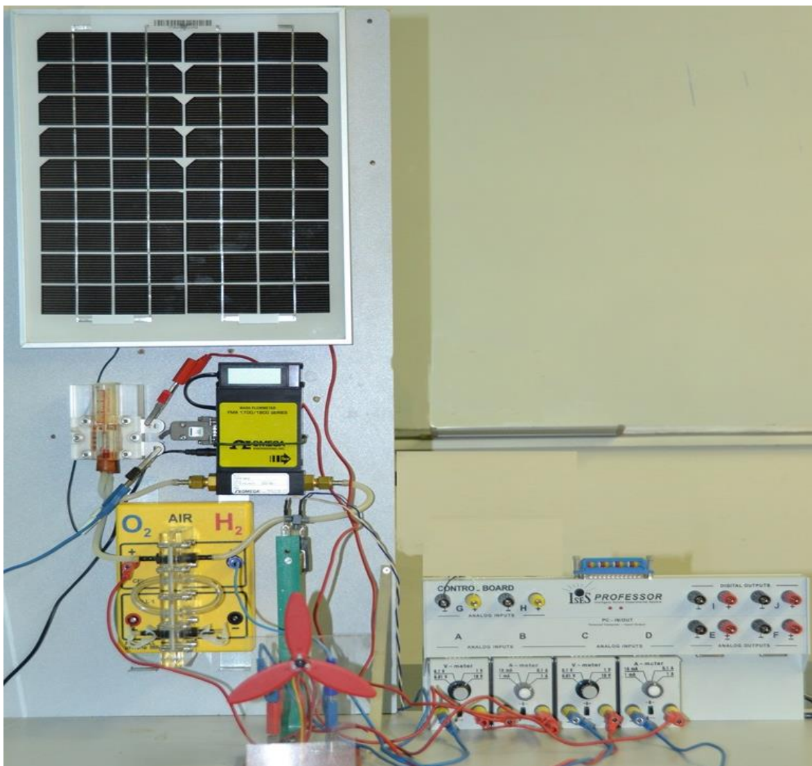
Obr. 7.6 Premena energie žiarenia na elektrickú energiu – komponenty reálneho vzdialeného experimentu [25]
