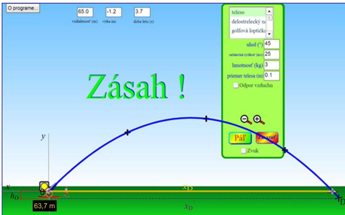
Obr. 7.6 Experimentovanie s interaktívnou simuláciou [1] pri nastavených vstupných hodnotách \alpha = 45^\circ , m = 3 \text{ kg} a v_0 = 25 \text{ m}\cdot\text{s}^{-1} vo vákuu
