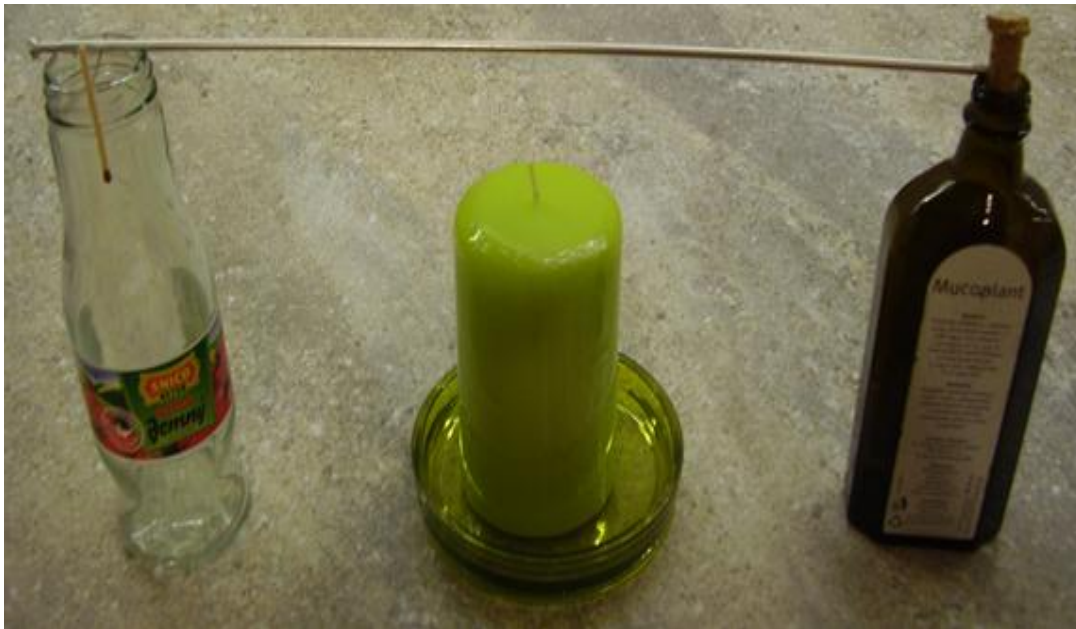
Obr. 20 Aparatúra na demonštráciu rozťažnosti látok (zohrievanie ihlice z hliníka)
