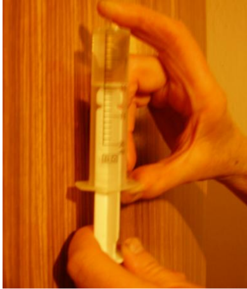
Obr. 10 Pomôcky pripravené na realizáciu pokusu prezentujúceho var vody pri zníženom tlaku
