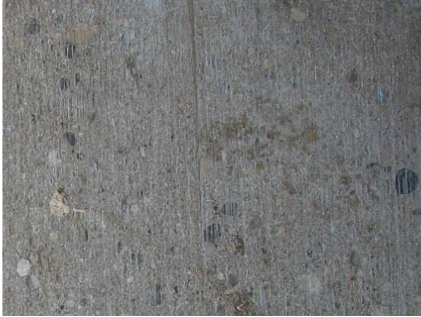
Obr.11 Hrubozrný baranecký pieskovec z lomu Trianová na bezbariérovom vstupe do Františkánskeho kostola v Trnave. (Foto: Hornáčková 2008)
